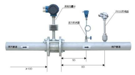
配管应与传感器同心,同轴度应<0.05D;密封垫不能凸入管道内,其内径可比传感器口径大1~2mm。
