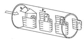
通过测量旋涡的分离频率便可测出流体流速和瞬时流量斯特劳哈尔数 St 是通过实验确定的无量纲常数。斯特劳哈尔数 St 与雷诺数 Re 的函数关系中的线性部分,即使涡街流量计的线性测量范围,检测出频率f可求得管内流体的速度,再由流速求得体积流量。一段时间内的脉冲数与流体的体积之比(流过单位体积流体的脉冲数)称之为仪表系数(K 系数)。
